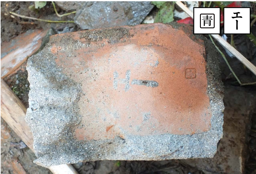
12ft 井筒用扇形異形煉瓦「エー」+「□+青」(揖斐川橋梁瓦礫・小口打刻)
