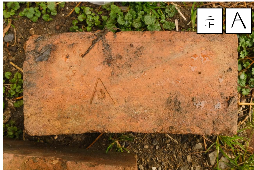
12ft 円形井筒用扇形異形煉瓦「A」＋「二十」（西尾市下町転石）
