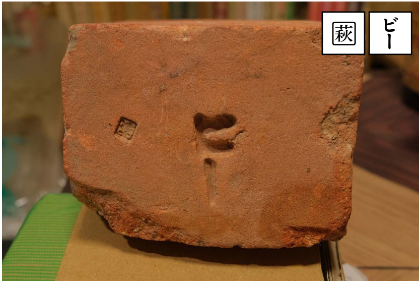
12ft 井筒用撥形異形煉瓦「ビー」+「□+萩」（揖斐川橋梁瓦礫・小口打刻）
