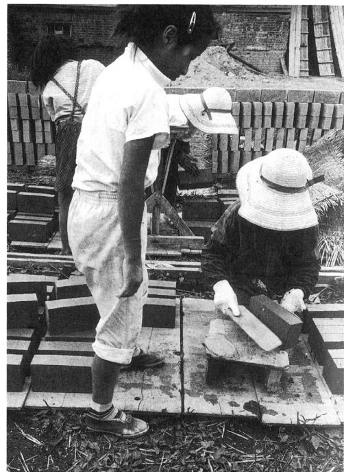
叩き板による整形作業（北海道野幌工場、藤倉徹夫『れんがと女』より引用）
